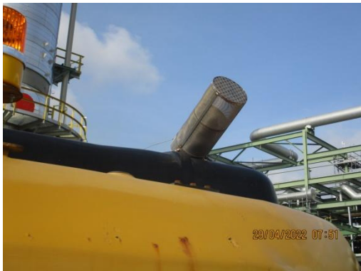
ภาพที่ 3.1-23 Spark Arrestor
